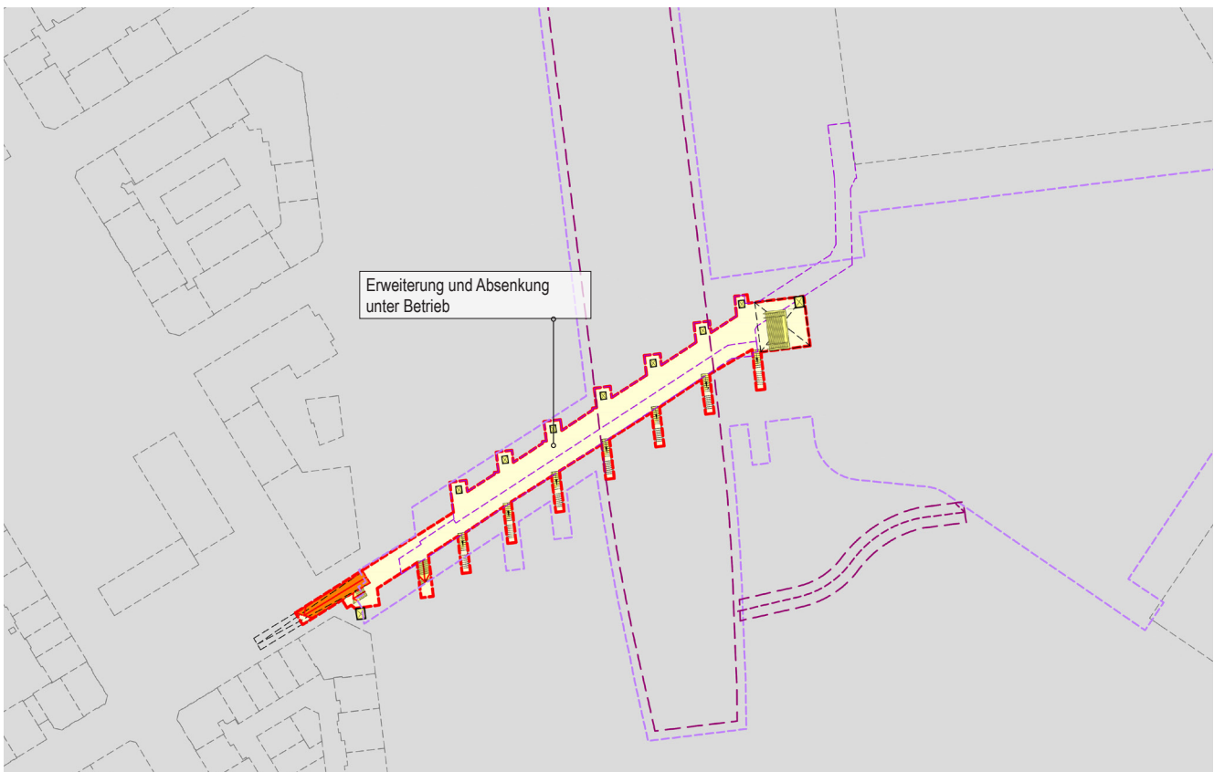
Personen-Unterführung Habsburgerstrasse, Bauphase DBL: Verbreiterung und Absenkung des Bodens der Unterführung unter Betrieb
