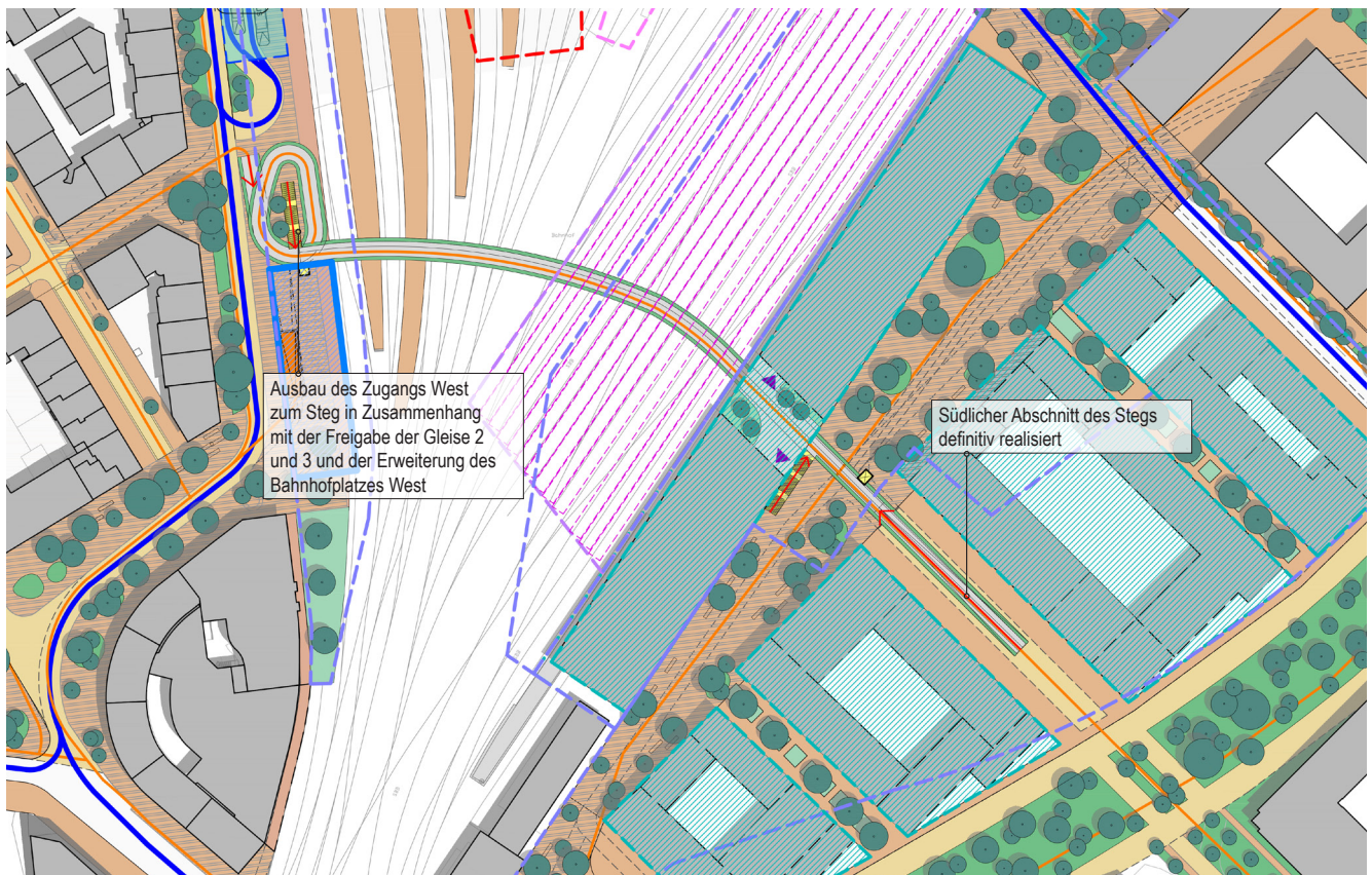
Rösslimattsteg, Eröffnung DBL: Ersatz des temporären südlichen Abschnitts des Stegs durch eine definitive Rampe in die Rösslimattstrasse
